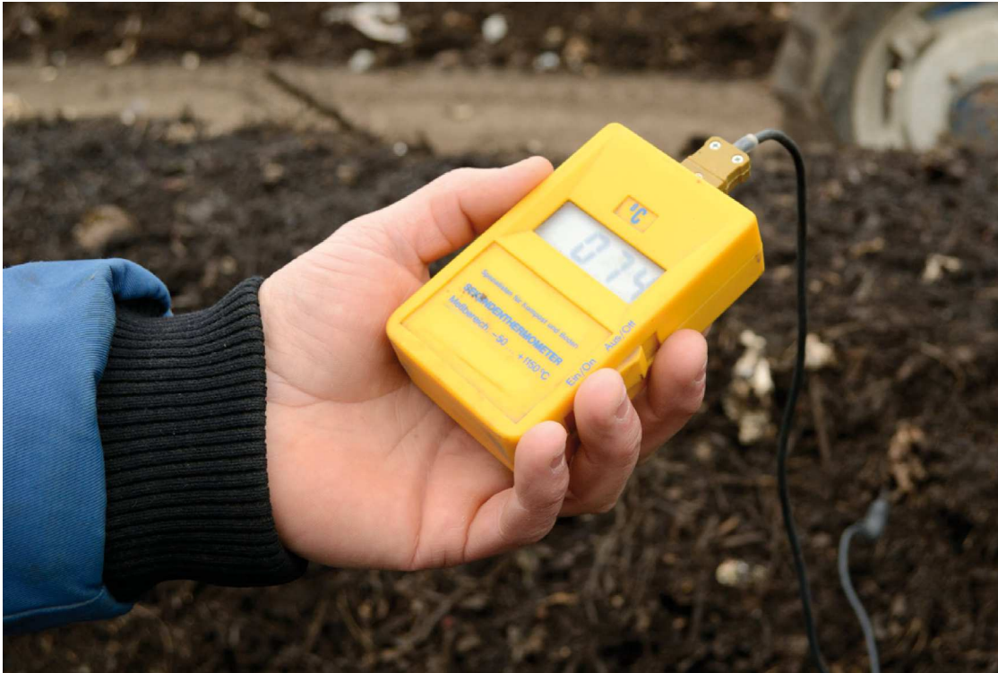
Eine Temperaturüberwachung im Kompostwerk sichert die Abtötung von Krankheitserregern und Unkrautsamen
